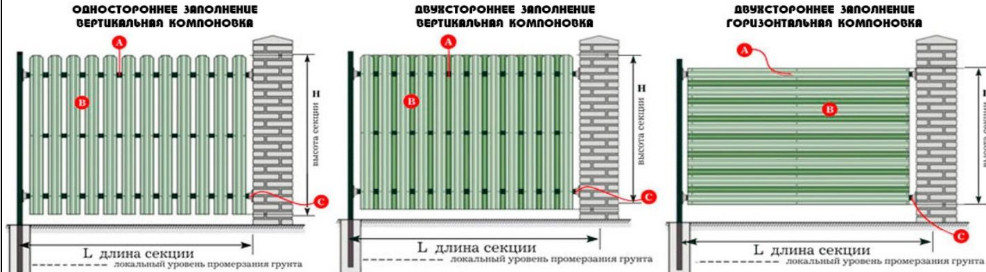
А - верхняя поперечина забора, В - евроштакетник от ТПК Центр Металлокровли, С - нижняя поперечина забора
