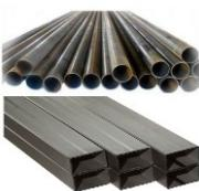
Трубы на столбы: НКТ Ø73мм или труба 60x40мм
